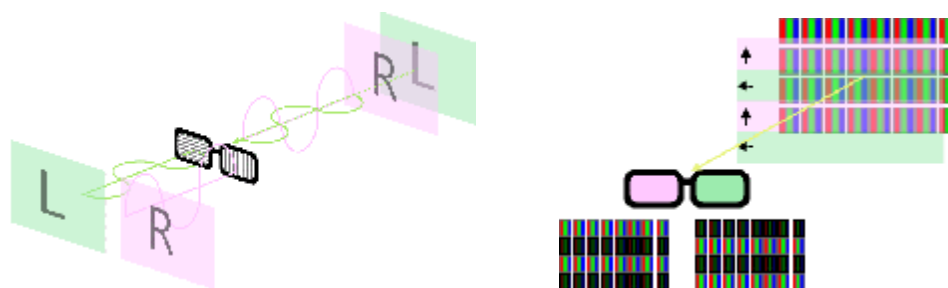
图 1 (a:偏光三维显示模式 b: 偏光三维显示器原理图)
